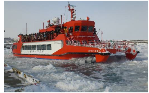
砕氷観光船:ガリンコⅡ (アルキメディアンズクレーで氷を砕く)
